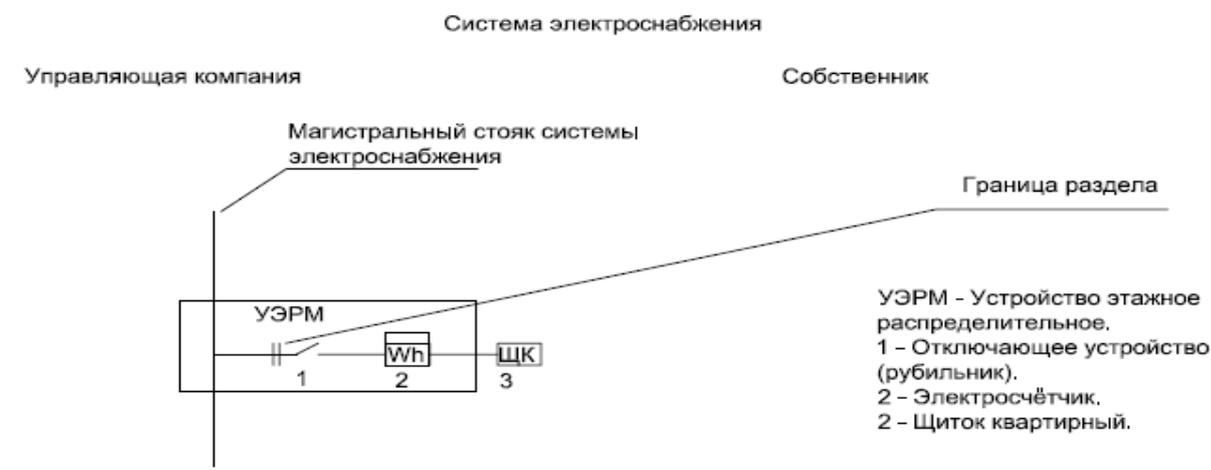
Стояковую разводку (общий кабель) и точки крепления наконечников обслуживает Управляющая организация, от рубильника (отключающего устройства) и точек крепления, отходящих к помещению, в том числе индивидуальный прибор учета электроэнергии - Собственник.
